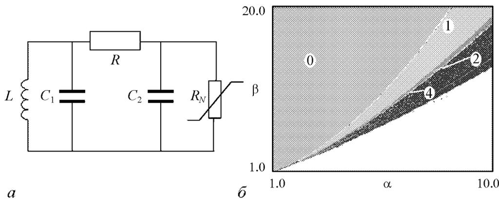
Рис. 2. *a* – принципиальный вид схемы, динамика которой описывается системой Чуа. Вольт-амперная характеристика нелинейного элемента задается соотношением (3). *б* – карта динамических режимов системы Чуа (2). Символом «0» отмечена область существования устойчивой неподвижной точки
