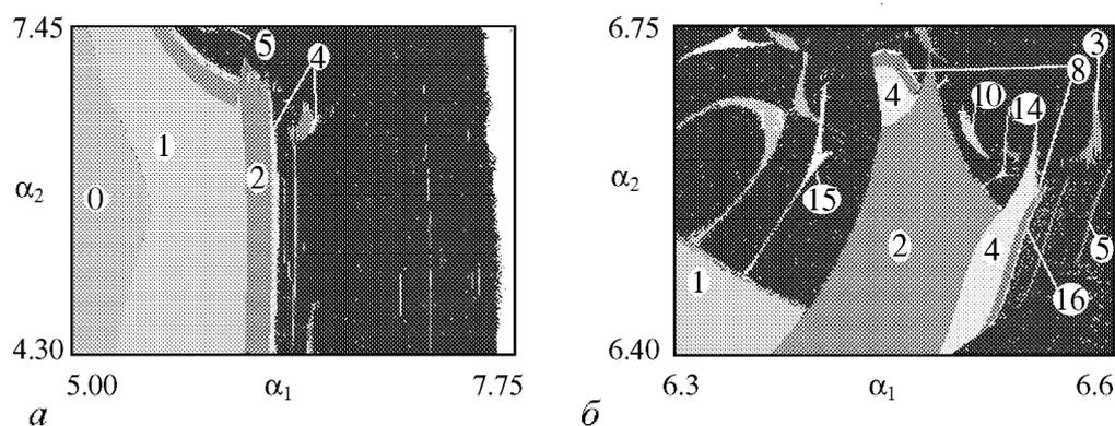
Рис. 3. *a* – карта динамических режимов системы (4); *б*) – ее увеличенный фрагмент в области, близкой к критической точке. Значения параметров подсистем  $\beta_1 = \beta_2 = 10$ , констант связи  $c_1 = 0.1$ ,  $c_2 = -0.05$
