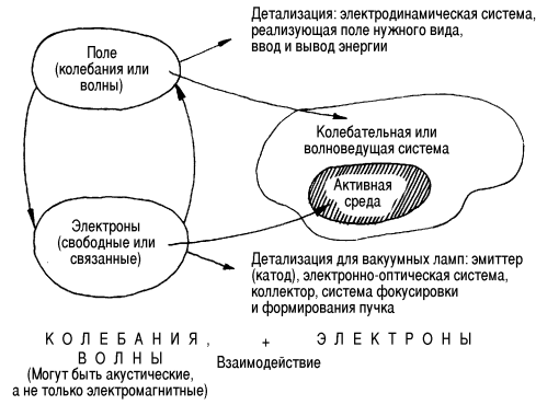
Рис. 1: Колебания, волны и электроны в электронных приборах.
