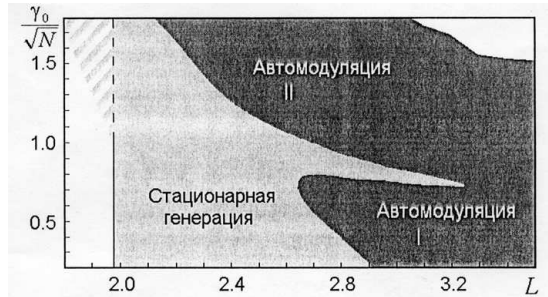
Рис. 12: Карта динамических режимов релятивистской ЛОВ на плоскости параметров L и \gamma_0/N , являющихся критериями подобия системы в асимптотике больших N . Белая область в левой части рисунка отвечает отсутствию генерации, чередующимися полосами белого и серого цвета показана область жесткого возбуждения. В белой области в правой верхней части диаграммы имеет место нарушение условий применимости уравнений ("остановка электронов").
